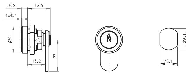
Schließweg: 90°, linksschließend, Zink-Druckguss glanzverchromt, 5 Plättchenzuhaltungen, 2 DOM Schlüssel nur in Sperrstellung abziehbar.
