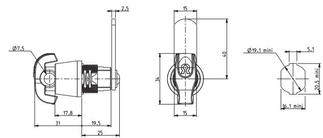
Schließweg: 90°, linksschließend, matt vernickelt, Vorhangschloss nur in Sperrstellung einsteckbar
