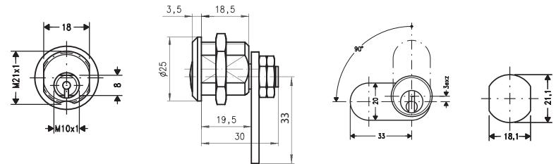
Schließweg: 90°, linksschließend, Messing Struktur Glanznickel, 5 Stiftzuhaltungen ø 2 mm, 2 DOM Schlüssel nur in Sperrstellung abziehbar. Schließanlagen geeignet.
