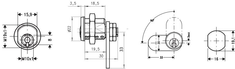
Schließweg: 90°, links- / rechtsschließend, Messing Struktur Glanznickel, 5 Stiftzuhaltungen ø 2 mm, 2 DOM Schlüssel in Sperr- und Offenstellung abziehbar.
