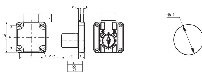
Zink-Druckguss matt vernickelt, 2 RONIS Schlüssel, vernickelt. Schlüssel in Sperr- und Offenstellung abziehbar. Riegelhub 11 mm.
