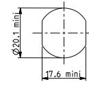
Schließweg: 180°, links & rechtsschließend, Zink-Druckguss glanzverchromt, 2 Ronis Schlüssel in 2 Stellung abziehbar
