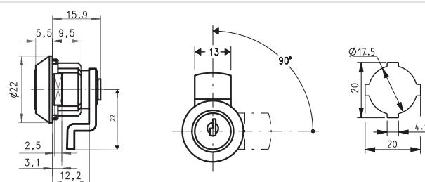
Schließweg: 90°, links- / rechtsschließend, Zink-Druckguss glanzverchromt, 5 Plättchenzuhaltungen, 2 DOM Schlüssel nur in Sperrstellung abziehbar.
