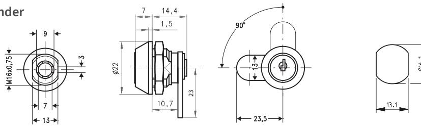
Schließweg: 90°, linksschließend, Zink-Druckguss glanzverchromt, 5 Plättchenzuhaltungen, 2 DOM Schlüssel nur in Sperrstellung abziehbar.
