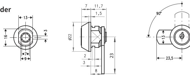
Schließweg: 90°, linksschließend, Zink-Druckguss glanzverchromt, 4 Plättchenzuhaltungen, 2 DOM Schlüssel nur in Sperrstellung abziehbar.
