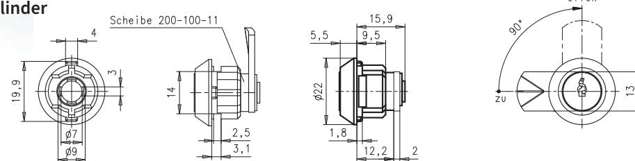
Schließweg: 90°, linksschließend, Zink-Druckguss glanzverchromt, 5 Plättchenzuhaltungen, 2 DOM Schlüssel in 1 Stellung abziehbar
