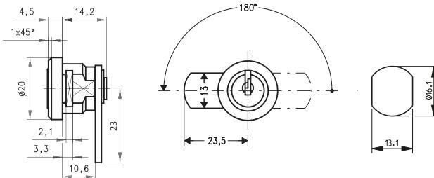
Schließweg: 180°, links- / rechtsschließend, Zink-Druckguss glanzverchromt, 4 Plättchenzuhaltungen, 2 DOM Schlüssel in Sperr- und Offenstellung abziehbar.
