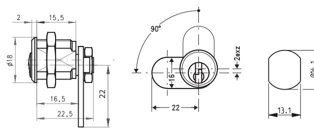
Schließweg: 90°, linksschließend, Messing Struktur Glanznickel, 5 Stiftzuhaltungen ø 2 mm, 2 DOM Schlüssel nur in Sperrstellung abziehbar.
