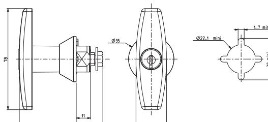
Schließweg: 90°, links & rechtsschließend, Zink-Druckguss glanzverchromt, 2 Ronis Schlüssel in 2 Stellung abziehbar
