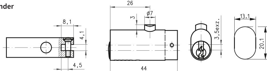
Schließweg: 90°, links & rechtsschließend, Messing Struktur Glanznickel, 4 Stiftzuhaltungen ø 2 mm, 2 DOM Schlüssel in Sperr & offenstellung abziehbar
