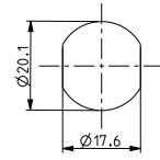
Schließweg: 180°, links & rechtsschließend, Zink-Druckguss glanzverchromt, 2 Ronis Schlüssel in 2 Stellung abziehbar
