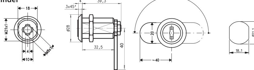
Schließweg: 180°, links- / rechtsschließend, Zink-Druckguss matt vernickelt, 10 Plättchenzuhaltungen, 2 DOM Wendeschlüsse in Sperr- u. Offenstellung abziehbar.
