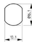
Schließweg: 90°, links & rechtsschließend, Messing Struktur Glanznickel, 4 Stiftzuhaltungen ø 2 mm, 2 DOM Schlüssel in Sperr & offenstellung abziehbar
