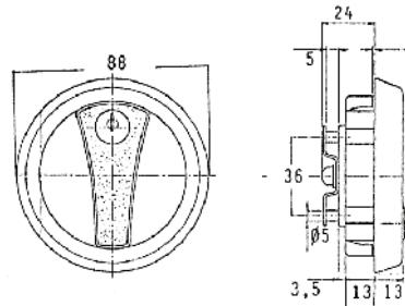
Schließweg: 90°, linksschließend, Zink-Druckguss, Kunststoff, 2 Ronis Schlüssel.
