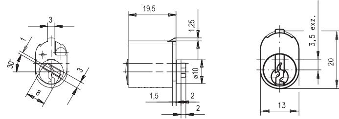
Schlüsseldrehweg 360°, matt vernickelt, 5 Stiftzuhaltungen, 2 DOM Wendeschlüsse in Sperr- u. Offenstellung abziehbar. Schließanlagen geeignet.
