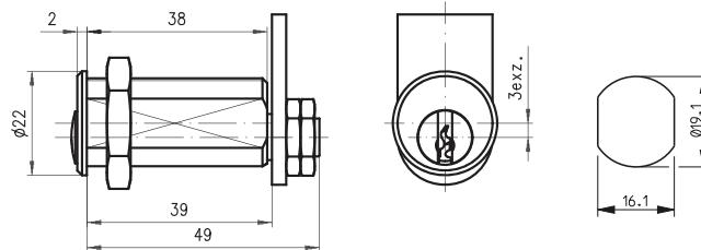
Schließweg: 90°, rechtsschließend, Messing Struktur Glanznickel, 5 Stiftzuhaltungen Ø 2 mm, 2 DOM Schlüssel nur in Sperrstellung abziehbar. Schließanlagen geeignet
