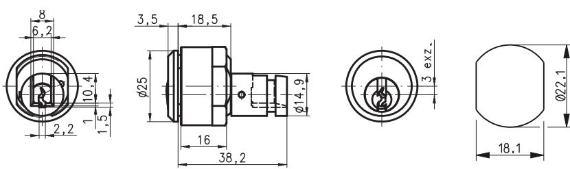
Schließweg: 360°, links- / rechtsschließend, Messing Struktur Glanznickel, 5 Stiftzuhaltungen Ø 2 mm, 2 DOM Schlüssel in Sperr- und Offenstellung abziehbar
