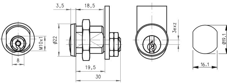
Schließweg: 90°, linksschließend, Messing Struktur Glanznickel, 5 Stiftzuhaltungen Ø 2 mm, 2 DOM Schlüssel nur in Sperrstellung abziehbar. Schließanlagen geeignet
