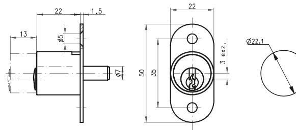
Schließweg: 90°, linksschließend, Messing Struktur Glanznickel, 5 Stiftzuhaltungen Ø 2 mm, 2 DOM Schlüssel nur in Sperrstellung abziehbar. Schließenanlagen geeignet
