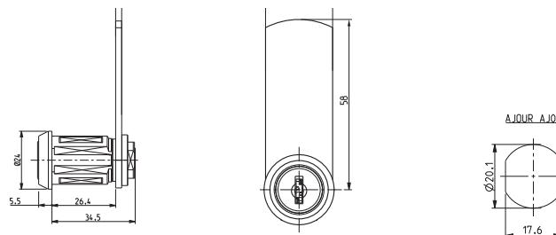
Schließweg: 180°, links & rechtsschließend, Zink-Druckguss glanzverchromt, 2 Ronis Schlüssel in 2 Stellung abziehbar
