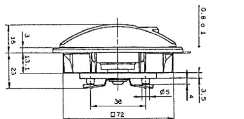
Schließweg: 90°, linksschließend, Zink-Druckguss. Kunststoff, 2 Ronis Schlüssel.
