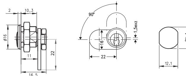
Schließweg: 90°, linksschließend, Messing Struktur Glanznickel, 3 Stiftzuhaltungen ø 2 mm, 2 DOM Schlüssel nur in Sperrstellung abziehbar.
