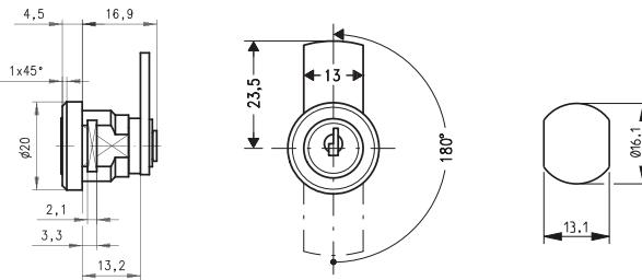
Schließweg: 180°, links- / rechtsschließend, Zink-Druckguss glanzverchromt, 5 Plättchenzuhaltungen, 2 DOM Schlüsse in Sperr- und Offenstellung abziehbar.
