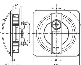
Schließweg: 90°, linksschließend, Zink-Druckguss. Kunststoff, 2 Ronis Schlüssel.
