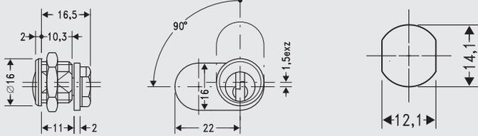
Zylinder: Messing, Struktur Glanznickel
