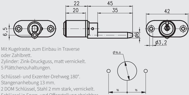
Mit Kugelraste, zum Einbau in Traverse oder Zahlbrett.
