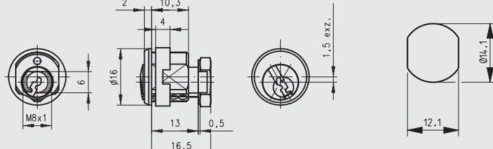
Zylinder: Messing, Struktur Glanznickel
