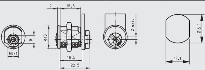
Zylinder: Messing, Struktur Glanznickel
