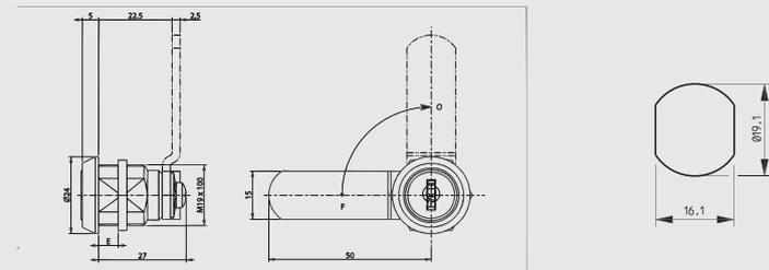
Zylinder: Zink-Druckguss, glanzverchromt
