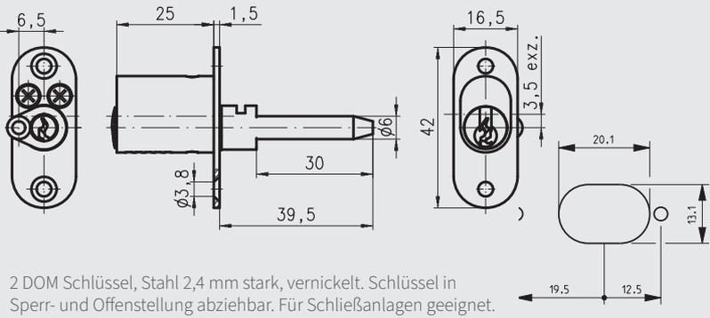
Zum Einbau in Traverse oder Zahlbrett. Zylinder: Messing, matt vernickelt.
