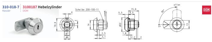
Schließweg: 90°, linksschließend, Zink-Druckguss glanzverchromt, 5 Plättchenzuhaltungen, 2 DOM Schlüssel in 1 Stellung abziehbar
