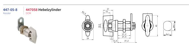
Schließweg: 90°, linksschließend, Matt verchromt, vernickelt, Vorhangschloss nur in Sperrstellung einsteckbar
